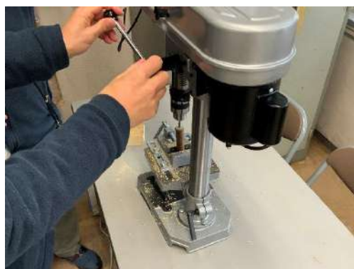
ボール盤での穴あけ作業
